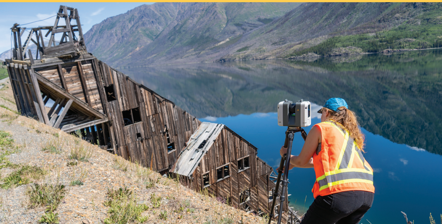
Escaneo 3D de la mina abandonada de Venus en el Yukon (Canadá) © Autor
